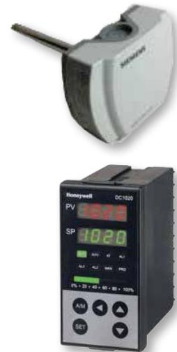
По дополнительному запросу горелки могут быть оснащены комплектом для модуляции мощности, состоящим из PID-регулятора и датчика состояния среды (датчик давления пара или датчик температуры), что обеспечивает точное поддержание температуры или давления теплоносителя в котле.
